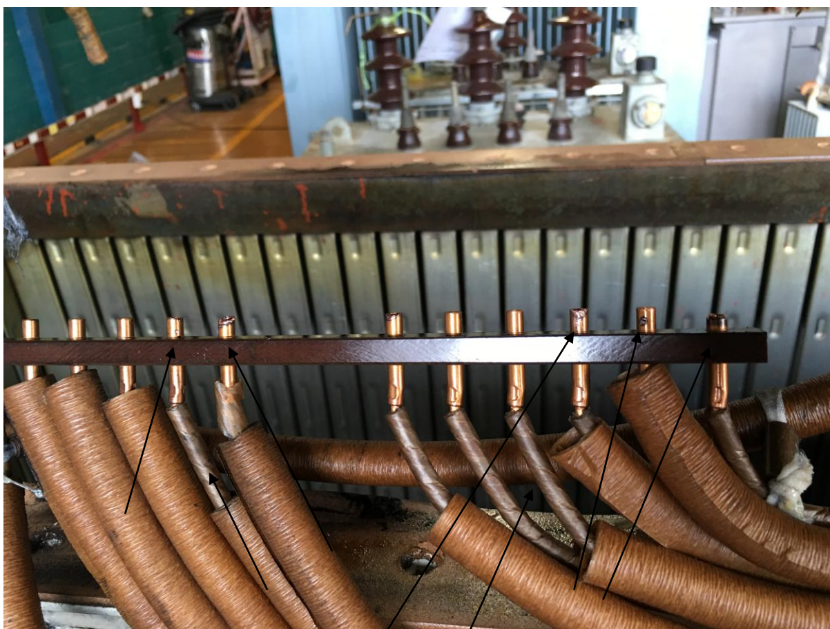
รูปที่ 3 พบมีรอย Arc เล็กน้อยที่ TAP เนื่องจาก Partial discharge
