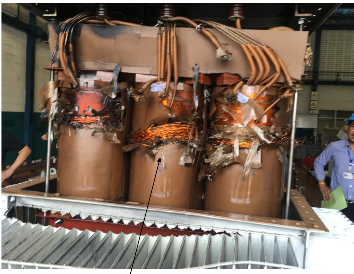
รูปที่ 2 พบการชำรุดเฉพาะขดลวด Tap เนื่องจากการ Short circuit ระหว่าง TAP
