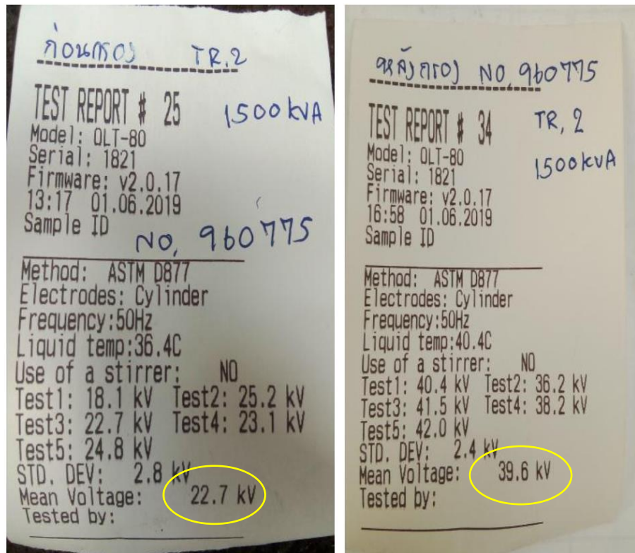
ภาพที่ 3 Dielectric strength breakdown voltage ผลการทดสอบต่ำกว่ามาตรฐานต่ำกว่า 30kV แก้ไขโดยการกรองน้ำมันหม้อแปลง
