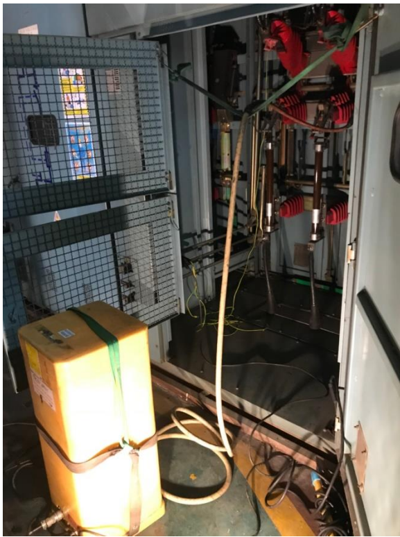
ภาพที่ 1 DC high port test ของ Underground cable ผลการทดสอบปกติ
