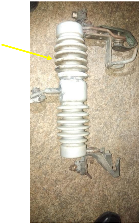
ภาพที่ 13 Fuse holder มีคราบของไขมันจับติดเหนียว
