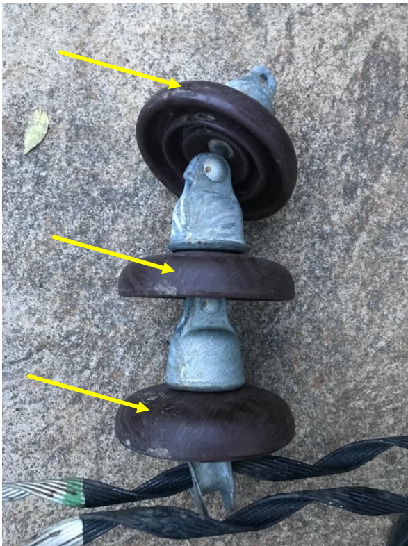
ภาพที่ 14 สายไฟและลูกถ้วยมีคราบของไขมันจับติดเหนียว
