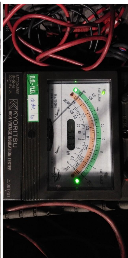
ภาพที่ 2 Insulation resistance test ของ Underground cable ผลการทดสอบปกติ
