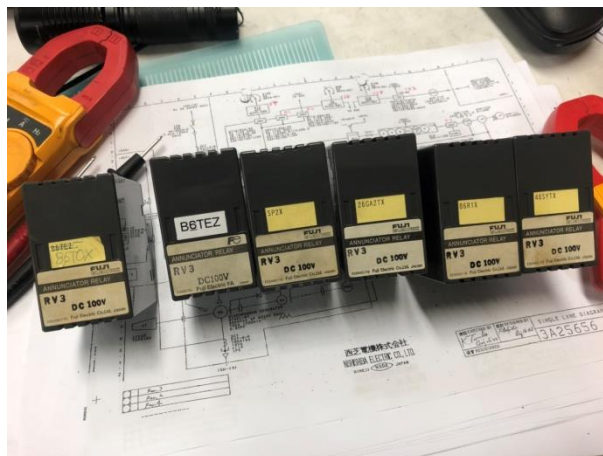
រូបទី ១០ រូបថត GCP Panel - Annunciator damage
