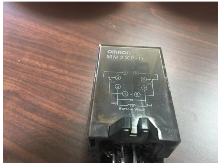
รูปที่ 8 ที่ GCP Panel - Flash over ที่ aux relay
