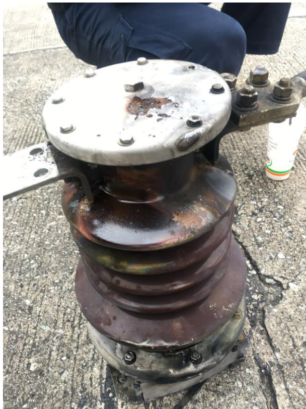
รูปที่ 16 CT ที่เสื่อมสภาพทำให้เกิด Fault
