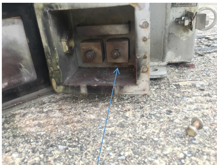
รูปที่ 4 Secondary terminal of PT เกิด Flash over
