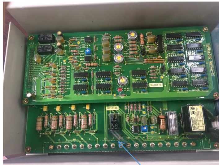
รูปที่ 6 ที่ GCP Panel - Flash over ที่ static voltage adjuster
