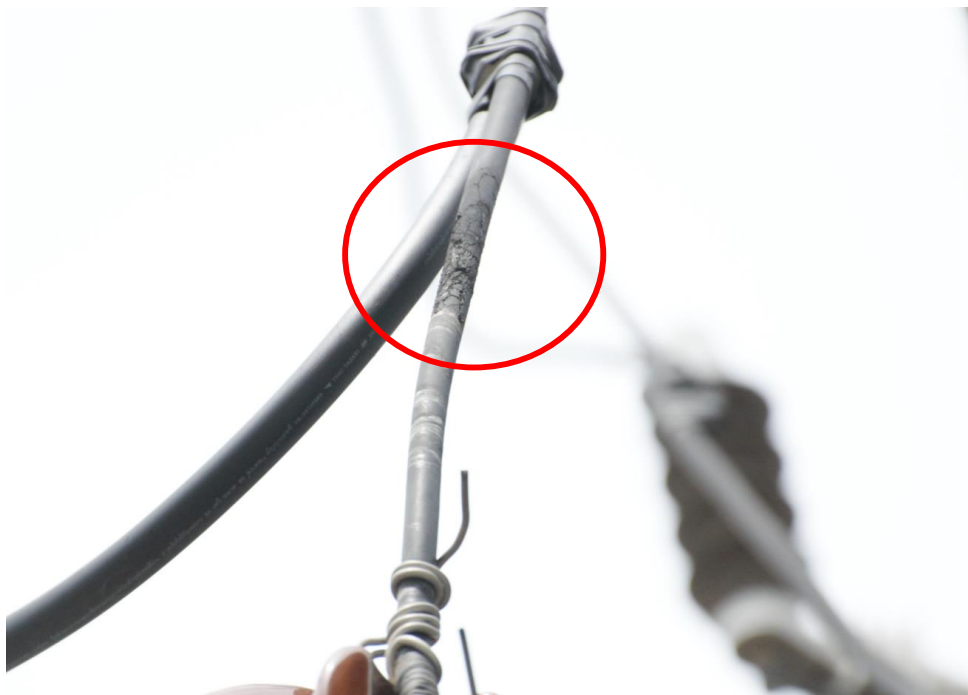
พบการชำรุดและเสื่อมสภาพของฉนวนที่ Cable ซึ่งเกิดจาก PD
