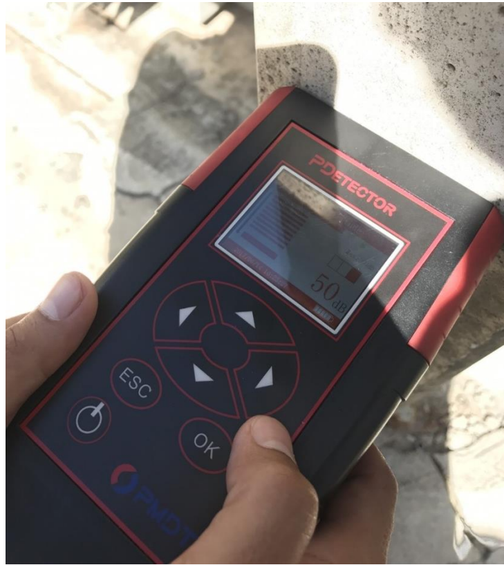
ตรวจพบ PD ด้วย TEV Mode ระดับความแรงสัญญาณ 50 dB
