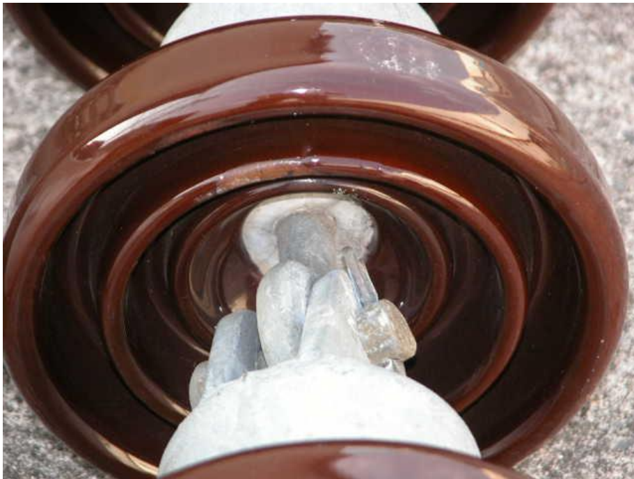
รูปที่ 3 ผลของการเกิด Partial discharge ที่ฉนวน (Insulator)
